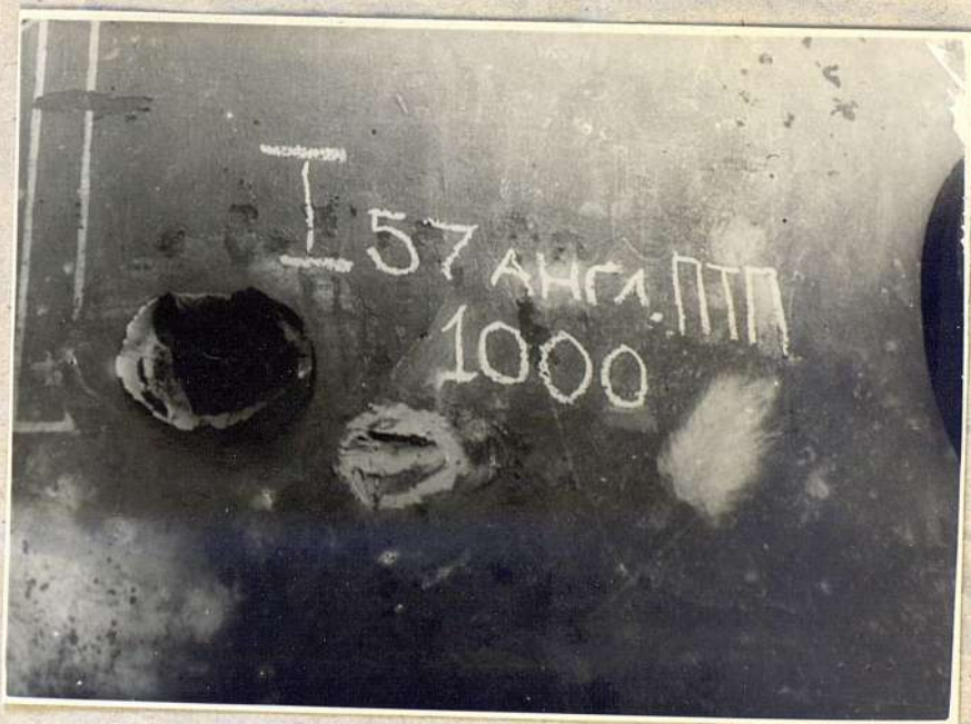
Фото № 16. Попадание бронебойного снаряда английской 57 мм противотанковой пушки в башню. Вмятина глубиной 90 мм, диаметром 90 мм. С внутренней стороны выпучина высотой 10 мм с трещинами. Дистанция обстрела 1000 метров.
