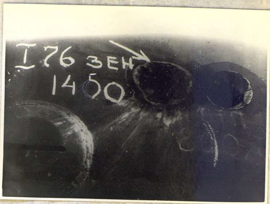
Фото № 27. Попадание бронебойного снаряда 76 мм зенитной пушки в башню. Вмятина диаметром 120 мм, глубиной 35 мм. Дистанция обстрела 1450 метров.
