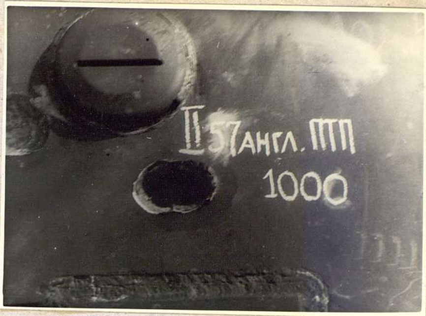
Фото № 17. Попадание бронебойного снаряда английской 57 мм противотанковой пушки в башню. Вмятина размером 120 x 80 мм, глубиной 70 мм. С внутренней стороны незначительная выпучина. Дистанция обстрела 1000 метров.
