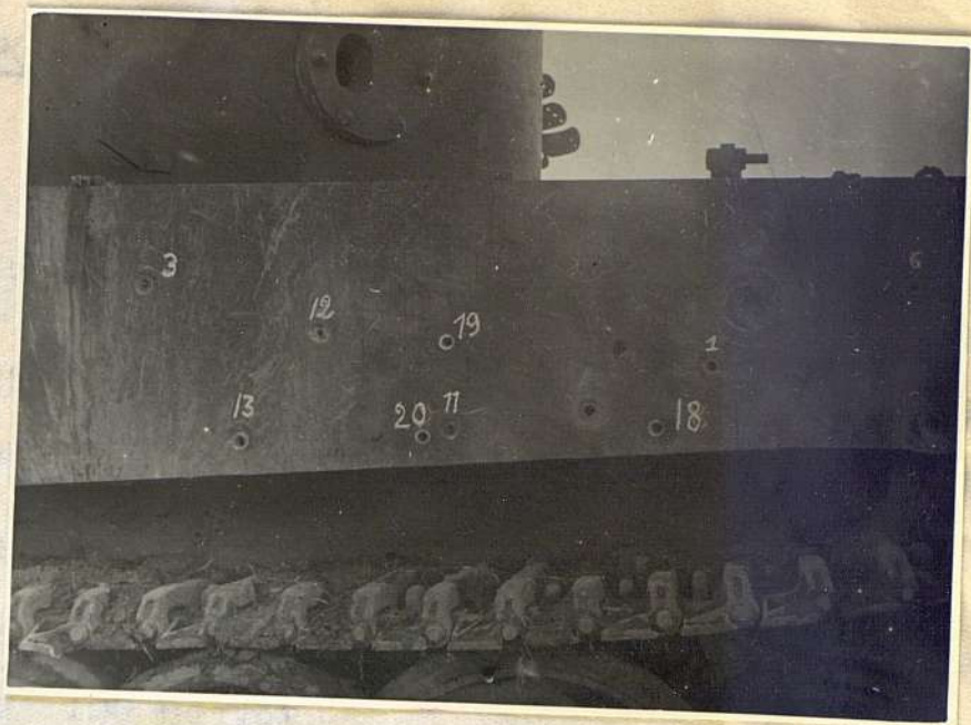
Фото № 42. Результаты обстрела бортового листа корпуса танка Т-34 из ПТР разных систем.
