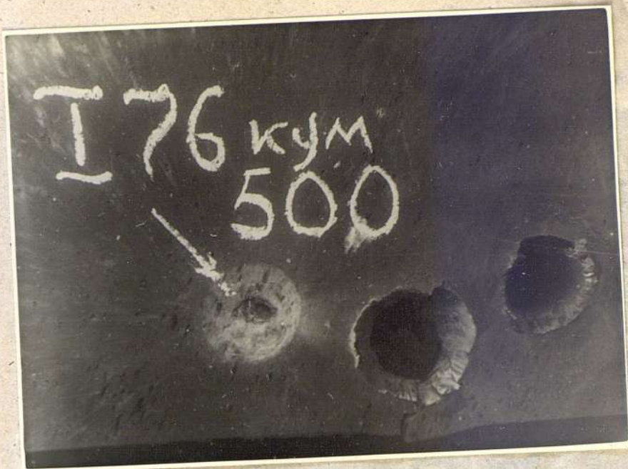
Фото № 21. Попадание кумулятивного снаряда (опытного) в борт. Вмятина размерами 35x20 мм, глубиной 20 мм. Дистанция обстрела 500 м.
