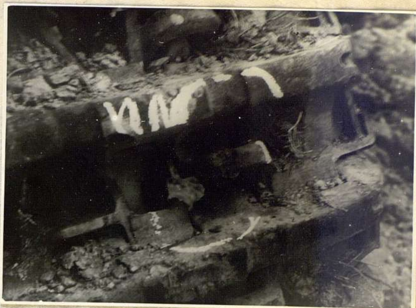
Фото № 44. Попадание бронебойно-трассирующего снаряда авиационной 37 мм пушки, установленной на самолете ИЛ-2, в гусеницу. Входное отверстие.
