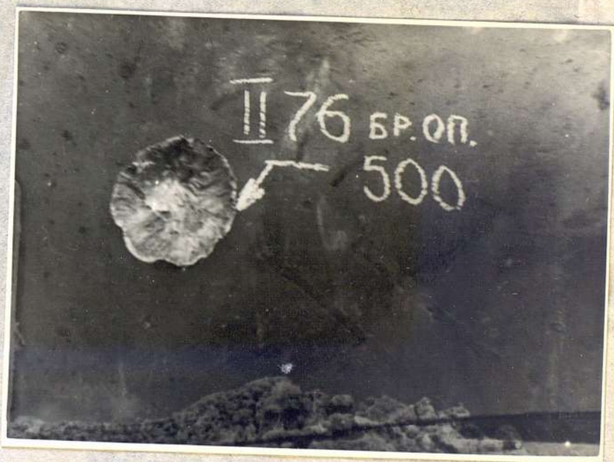
Фото № 24. Попадание бронебойного (опытного) снаряда пушки Ф-34 в лобовой лист. Вмятина глубиной 30 мм, диаметром 110 мм. Дистанция обстрела 500 м.
