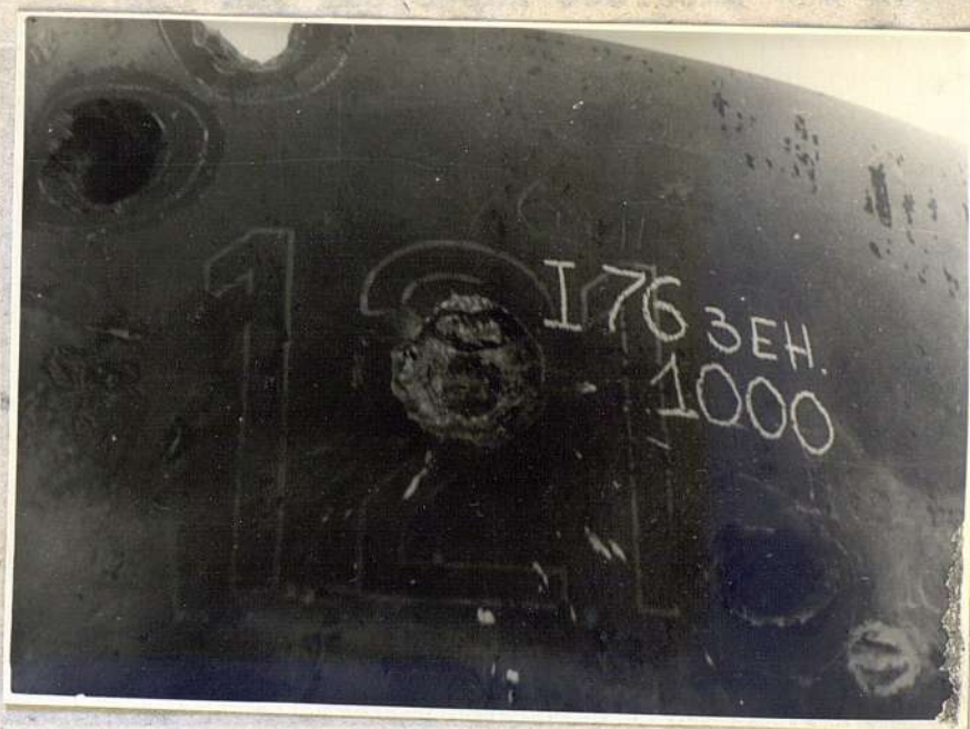
Фото № 23. Попадание бронебойного снаряда 76 мм зенитной пушки в башню. Вмятина диаметром 105 мм, глубиной 30 мм. Дистанция обстрела 1000 метров.
