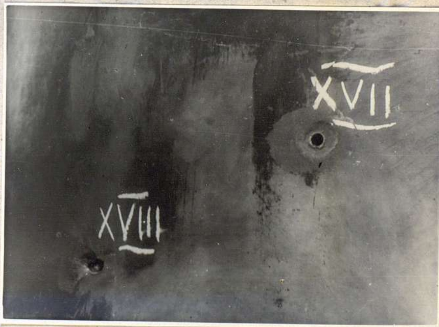
Фото № 6. Попадания в борт подкалиберных снарядов 45 мм танковой пушки.
