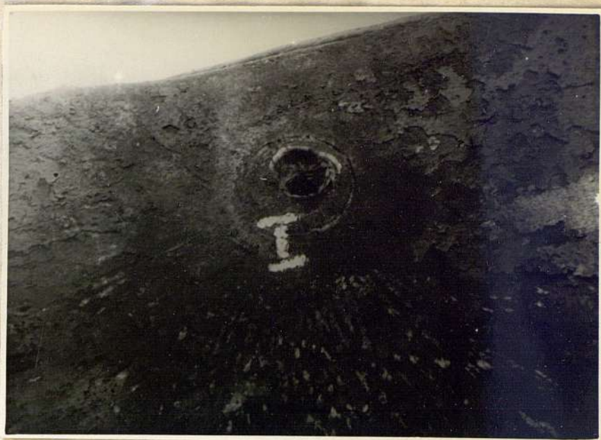
Фото № 38. Попадание гранаты в борт. Выятина глубиной 37 мм, диаметром 30 мм. С внутренней стороны выпучина с надрывом.
