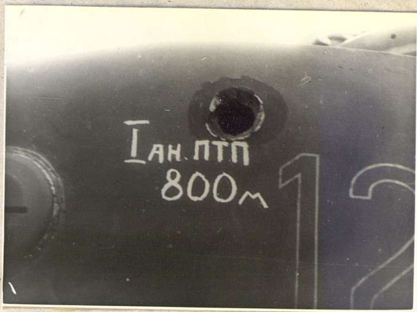
Фото № 15. Попадание бронебойного снаряда английской 57 мм противотанковой пушки в башню. Сквозная пробоина. Входной диаметр 32 мм, выходной - 75 мм. Дистанция обстрела 800 метров.
