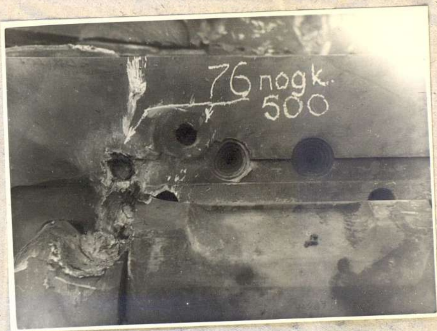
Фото № 21. Попадание кумулятивного снаряда (опытного) в борт. Вмятина размерами 35x20 мм, глубиной 20 мм. Дистанция обстрела 500 м.
