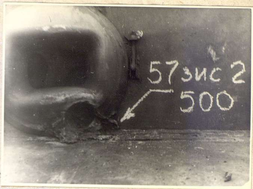
Фото № 13. Попадание бронебойного снаряда пушки ЗИС-2 в верхний лобовой лист. Вмятина диаметром 90 мм, глубиной 20 мм. Дистанция обстрела 500 м.
