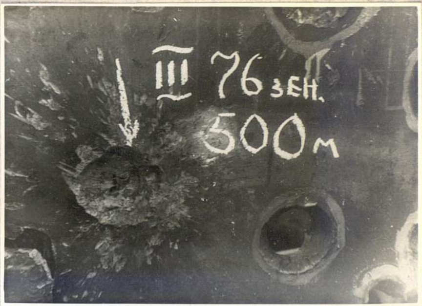
Фото № 20. Попадание бронебойного снаряда 76 мм зенитной пушки в башню. Вмятина глубиной 45 мм, диаметром 110 мм. Дистанция обстрела 500 метров.
