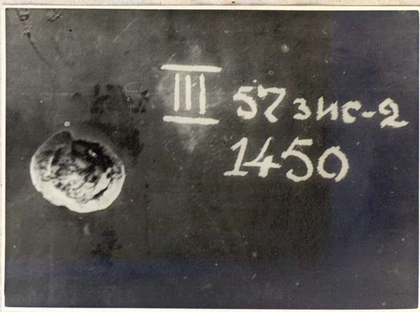
Фото № 10. Попадание бронебойного снаряда пушки ЗИС-2. в башню. Вмятина глубиной 70 мм и диаметром 110 мм. С внутренней стороны выпучина с надрывом. Дистанция обстрела 1450 м.
