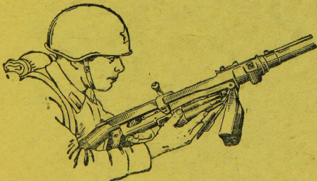
Рис. 7. Вкладывание обоймы с патронами в магазин
