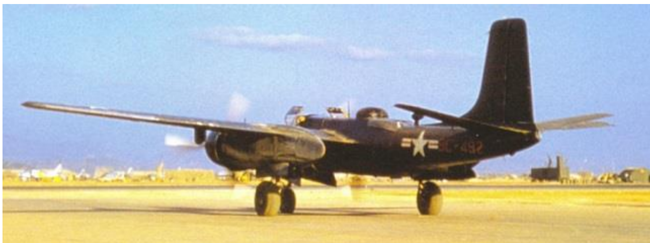
RB-26C 12-го эскадрона с «колпаком» выруливает на взлёт. Разведчиков отличали по полностью покрашенному черным хвосту.
