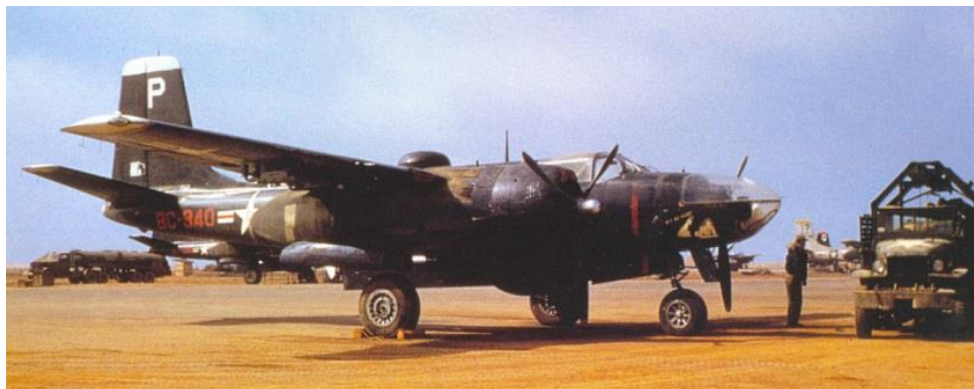
В-26С из 90-го эскадрона, 3-й бомбардировочной группы (авиакрыла) с «колпаком» SHORAN вместо пулемётной турели.
