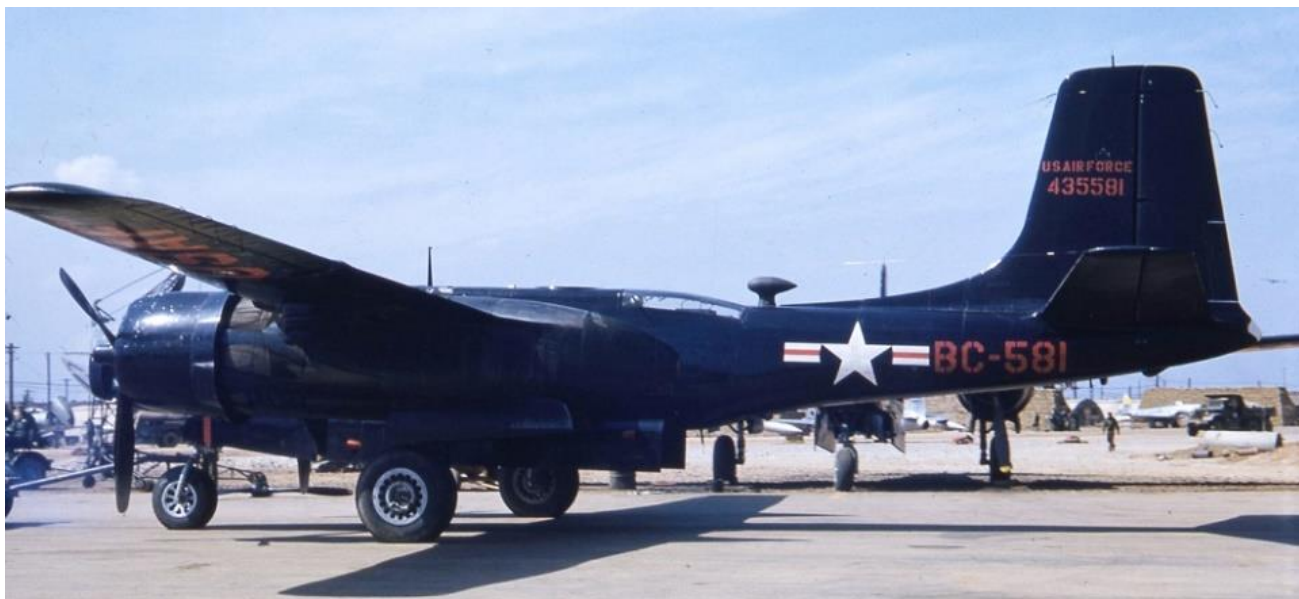
RB-26C на авиабазе Кунсан, 1951 г. без «колпака». На месте турели заметен круглый посадочный «наплыв».
