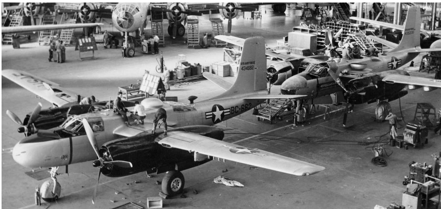
Ремонт и переоборудование В-26 в технико-логистическом центре в г.Огден (Юта) на авиабазе ВВС США «Хилл», начало 1950-х. Видна установка «куполов» вместо пулёмётных турелей.
